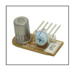
정기적으로 센서 교환을 할 경우에는. Connecter Pin으로 쉽게 모듈의 수 있도록 고려했습니다. 입출력 Connecter Pin이 포함되어 있으므로, 가스경보기의 주 회로기판에 실장도 간편합니다. 또한, 실장하는 센서 모듈을 메탄 검지용 NGM2611-E13으로 변경하는 것만으로도, 메탄용과 LP가스용의 두 종류의 가스 경보기에 같은 주 회로기판을 사용하는 것도 가능해졌습니다.
